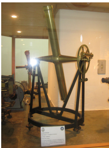
Figura 5 - Astrolábio de prisma A. Jobin. Foto do autor.
