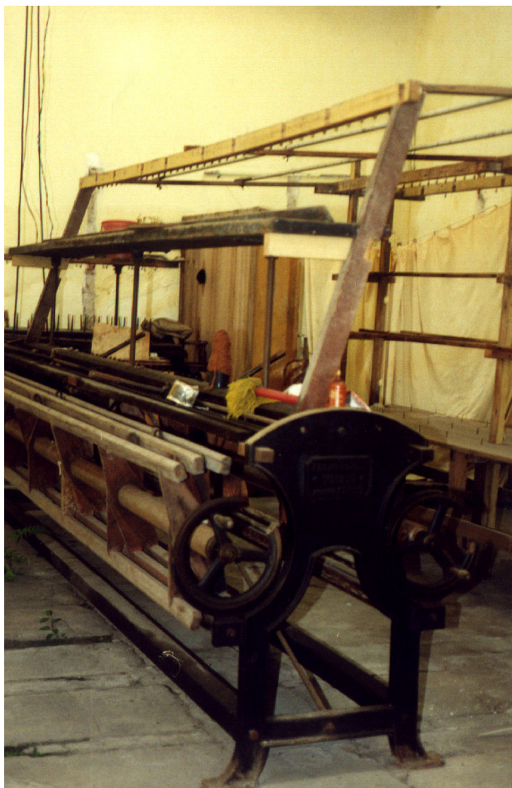
Imagem 4 - Tear semi-automático de procedência belga. Fonte: Foto da autora.
