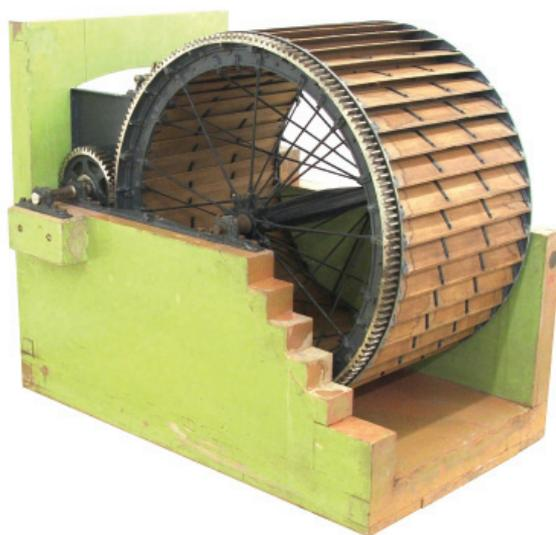
Roda Hidráulica vertical, recebendo água por um dos lados com escoamento e corredeira (núcleo de hidráulica).
