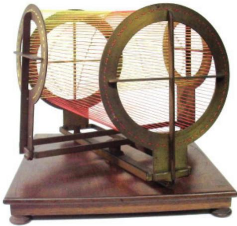
Modelo de Geometria Descritiva, penetração de dois cilindros. (núcleo de Matemática).
