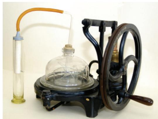
Sistema de filtração de injetáveis e enchimento de ampolas. (Foto: acervo MF/UFJF)
