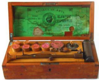
Caixa de maçarico de sopro (blowpipe) para análise de minerais, J. T. Letcher, GB.
