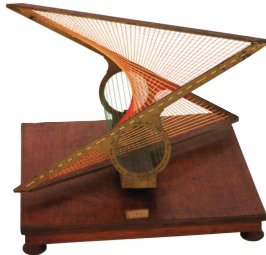
Modelo de Geometria Descritiva, intersecção de cilindro com um parabolóide hiperbólico. (núcleo de Matemática).
