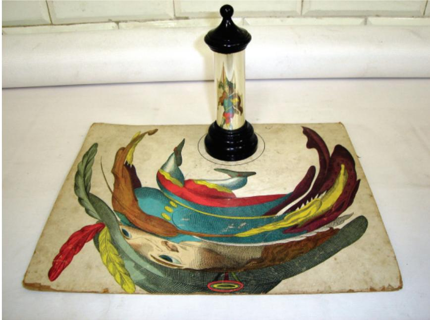
Espelho cilíndrico com anamorfose. (Foto: acervo MAST)
