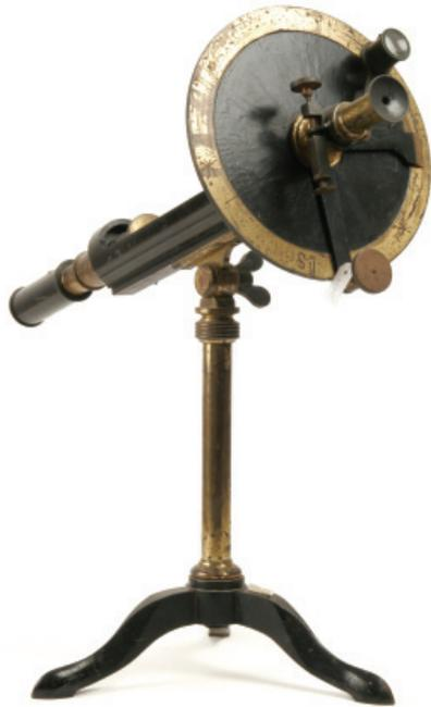
Polarímetro/Sacarímetro de Duboscq, (núcleo de química). (Foto: acervo MISE/UP)
