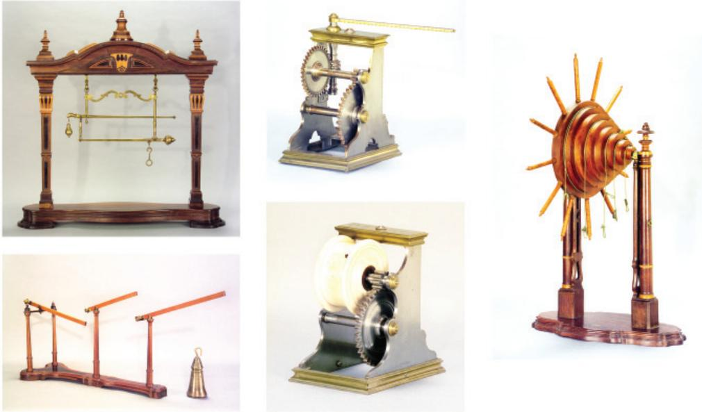
Instrumentos do Gabinete de Física executados a partir da tabela XI de 's Gravesande: balança romana composta, alavanca tripla, modelo de sarilho e duas máquinas compostas. (Foto: acervo GF/UC)
