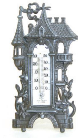
Termômetro com escalas Réaumur e Celsius de temperatura. (Foto: acervo MF/UFJF)
