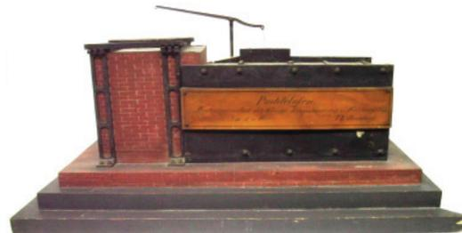
Modelo à escala de forno de revérbero para pudragem, (núcleo de Minas e Metalurgia). (Foto: acervo MISE/UP)
