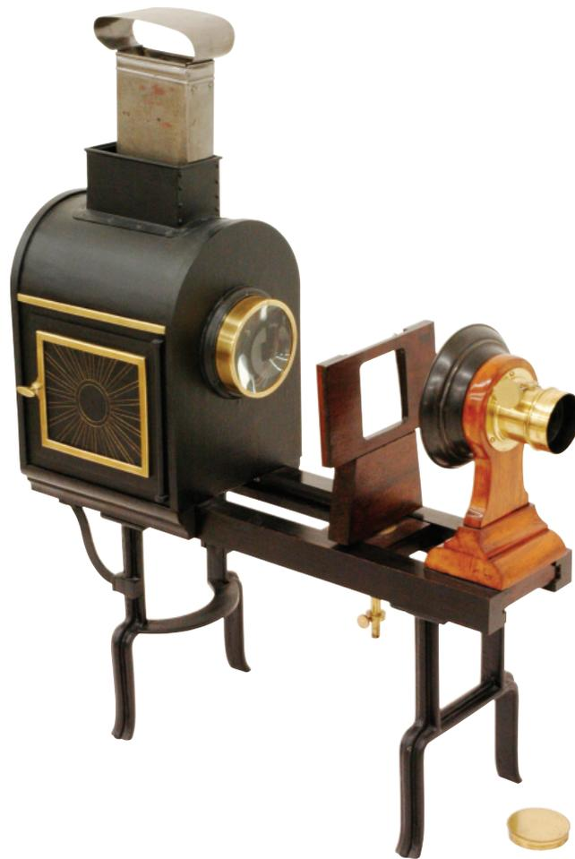
Lanterna Mágica ou Lanterna de projeção (ótica - Núcleo de física).
