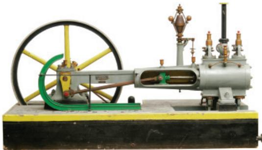
Modelo de máquina a vapor horizontal com distribuição Sulzer (núcleo de mecânica).
